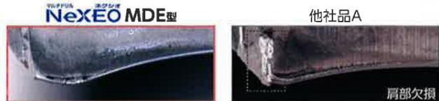
合金鋼加工 P 被削材:SCM415 切削条件:vc=110m/min f=0.2mm/rev 内部給油(水溶性)
