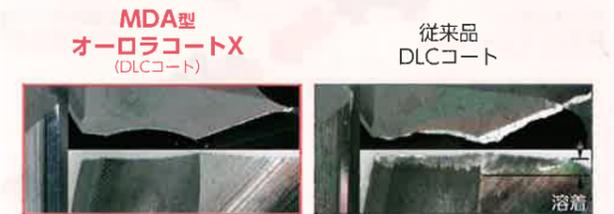
被削材: ADC12 設備: 立形MC BT30 使用工具: MDA0600S06H05 (φ6mm×5D)
