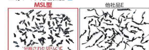
被削材:S5400 設備:立形MC BT50 内部給油2MPa 使用工具:φ14×5D用
