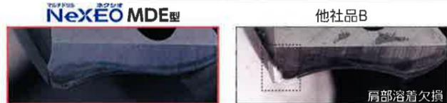
ステンレス鋼加工 M 被削材:SUS304 切削条件:vc=60m/min f=0.1mm/rev 内部給油(水溶性)
