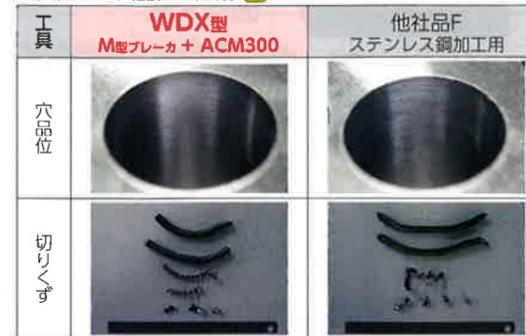
被削材:SUS316L 使用工具:WDX200D3S25 インサート:WDXT063006-M(ACM300)
